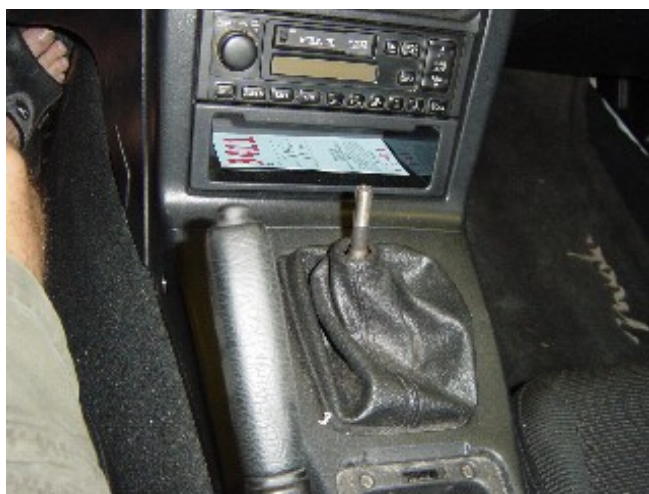
Photo 1-A: Remove the shift knob
